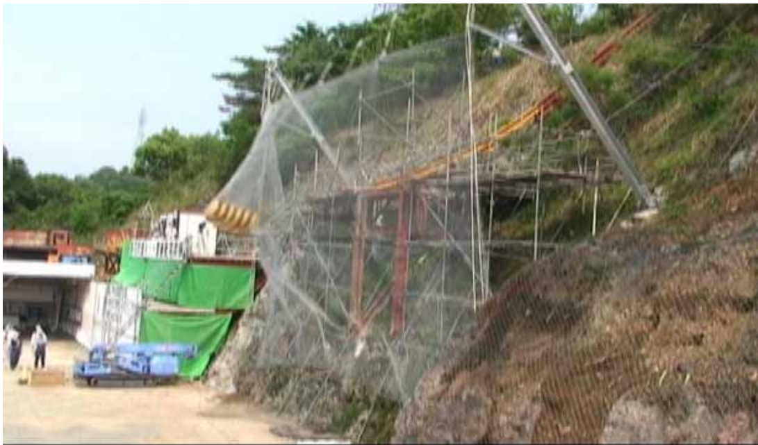
落石防護ネット・ロングスパンの重錘衝突実験の様相
