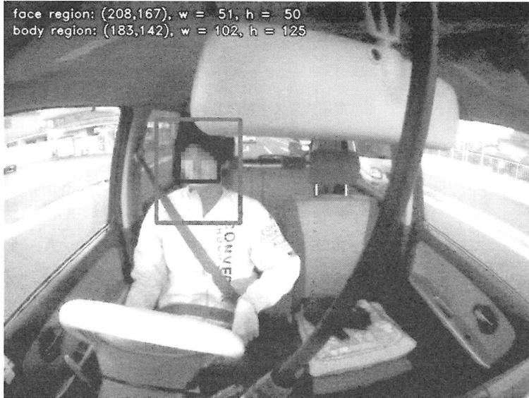
図1 OpenCV を用いた顔検出の結果とドライバーの上半身領域
