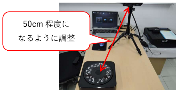
スキャナブラケットとターンテーブルとの距離の調整
