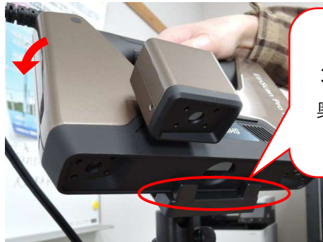
3D スキャナの三脚への固定方法
