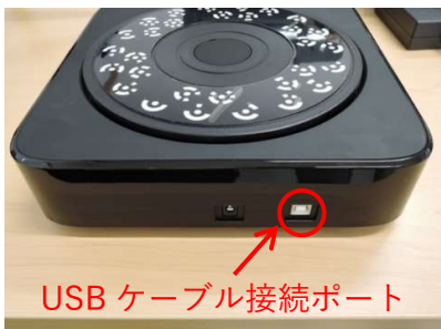
USB ケーブル接続ポート ターンテーブルの接続ポート
