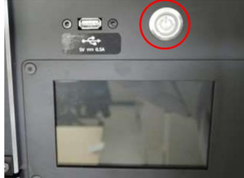
③ 機械の背面にある主電源スイッチを OFF にする。
