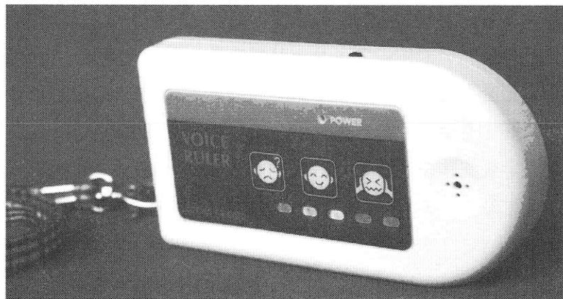
図3 声量フィードバック装置（声のものさし：ボイスルーラー）
